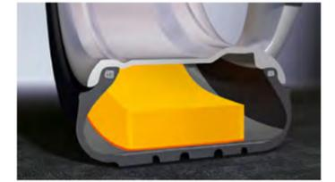
So funktioniert's: Eine Schicht Polyurethanschaum wird auf der Innenseite der Reifenlauffläche angebracht, um die Hohlraumgeräusche im Reifeninneren zu dämpfen und zu verhindern, dass sie über die Karosserie übertragen werden. Die Fahrgeräusche gelangen nicht über den Reifen ins Wageninnere. Der Schaumstoff verhindert, dass die Vibration der Straße vom Reifen über das Rad und die Achse auf die Fahrgastzelle übertragen wird, und reduziert damit die Fahrgeräusche im Auto.
