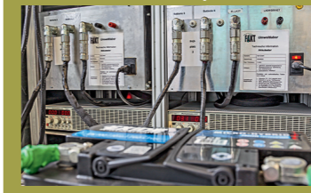
Der spezielle Prüfstand simuliert die Lastentnahme der Verbraucher im Auto
