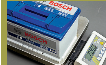
Gewichtsmessung – die Bleimasse ist entscheidend für die Kapazität
