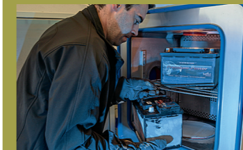
Vorbereitung für die Kälteprüfung: Unterkühlung im Frostschrank
